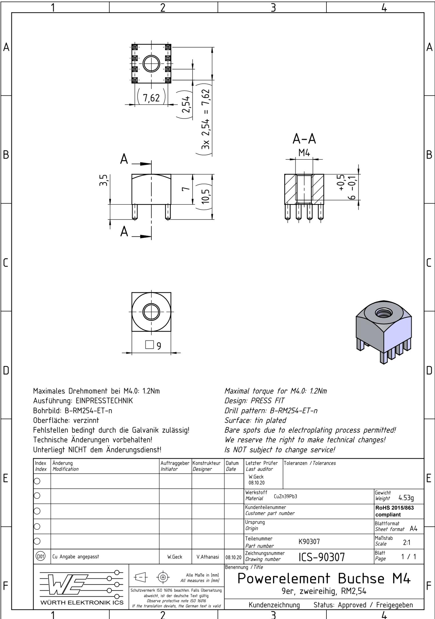
Maximales Drehmoment bei M4.0: 1.2Nm
