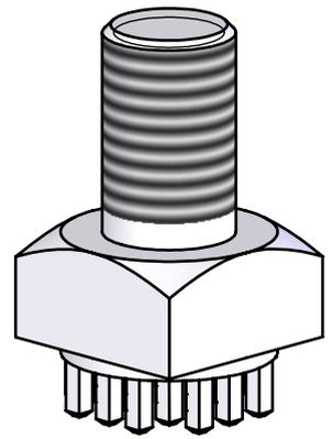
Maximales Drehmoment bei M8.0: 9.0Nm
