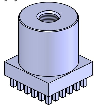
**Maximales Drehmoment bei M6: 3,9Nm**
