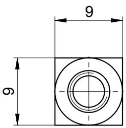
Max.zulässiges Drehmoment bei M5: 2,2Nm
