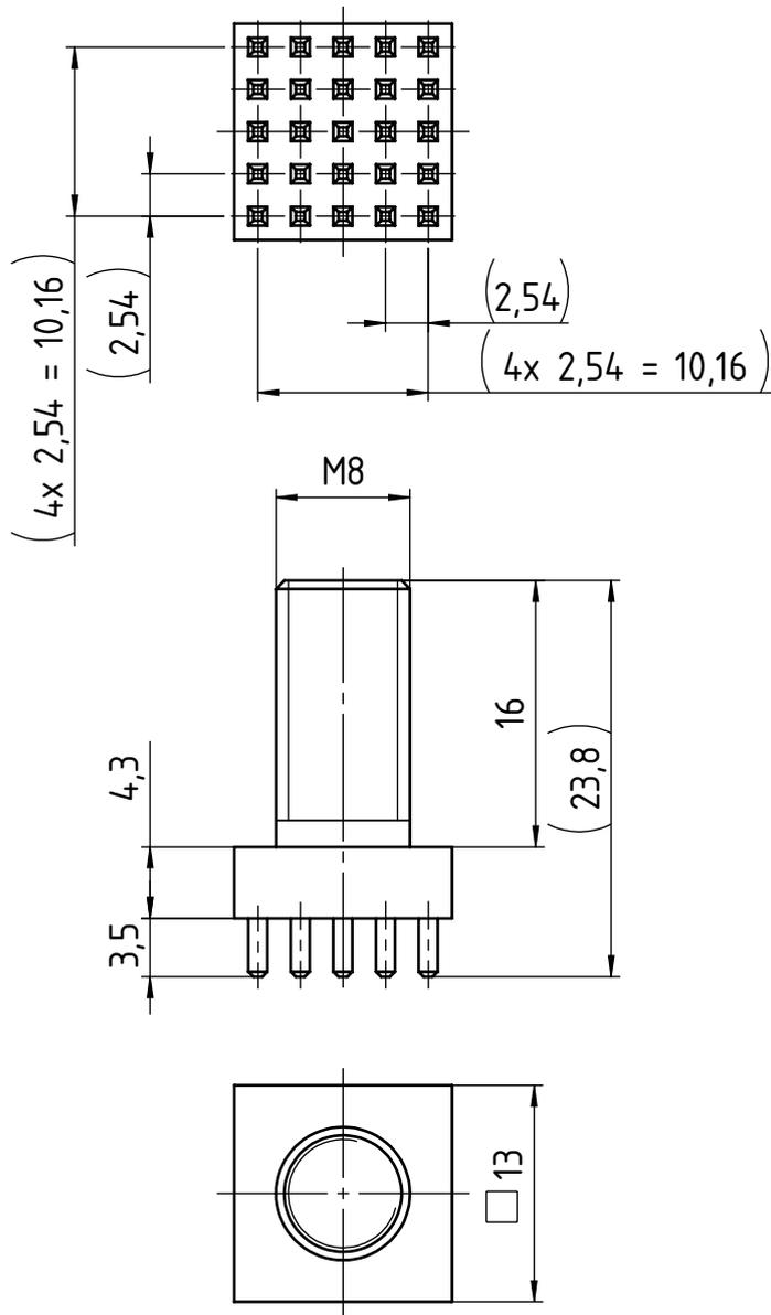
Maximales Drehmoment bei M8.0: 9.0Nm
