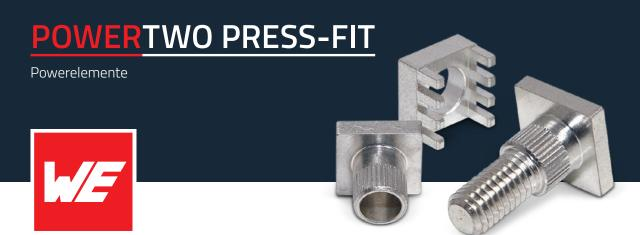
PowerTwo Press-fit Powerelemente sind zweiteilige Hochstromkontakte und eine von Würth Elektronik ICS patentierte Lösung für die Schraubtechnik auf Leiterplatten. Sie ermöglichen eine dauerhafte und zuverlässige Verbindung bzw. Befestigung auf der Leiterplatte, ohne diese selbst zu belasten. Abhängig von der Pin-Anordnung und dem entsprechenden Layout sind Ströme bis 500 Ampere möglich. Die Fertigungsmethode ermöglicht individuelle Anpassungen in den Abmaßen.
