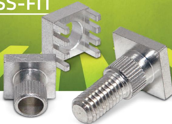
**LF PowerTwo Press-fit** Powerelemente sind zweiteilige bleifreie Hochstromkontakte und eine von Würth Elektronik ICS patentierte Lösung für die Schraubtechnik auf Leiterplatten. Sie ermöglichen eine dauerhafte und zuverlässige Verbindung bzw. Befestigung auf der Leiterplatte, ohne diese selbst zu belasten. Abhängig von der Pin-Anordnung und dem entsprechenden Layout sind Ströme bis 500 Ampere möglich.
