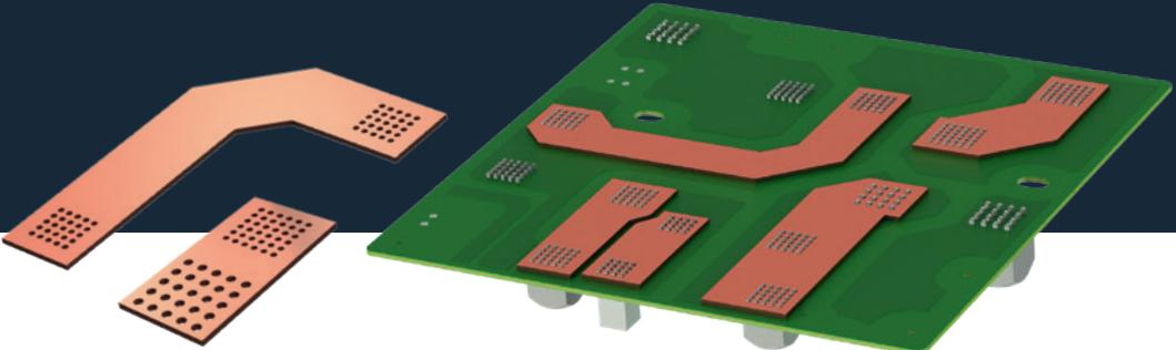
**PowerBusbar PCB** sind Kupfer-Stromschienen von Würth Elektronik ICS. Sie werden insbesondere dort eingesetzt, wo hohe Ströme gezielt auf Leiterplatten verteilt werden müssen. Dabei werden die Kupfer-Stromschienen zusammen mit den Würth Elektronik ICS Powerelementen und den Leiterplatten in einem Arbeitsgang verpresst. Das PowerBusbar Design wird vom Kunden als Outline zur Verfügung gestellt und von uns fertigungsgerecht ausgelegt.
